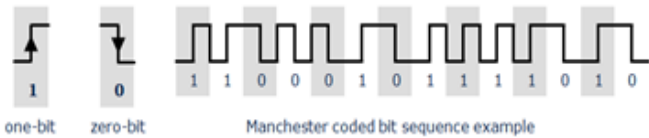
Fig. 4. Manchester Coding (DC-free)
